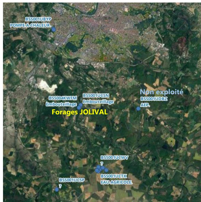
Figure 36 : Forages inclus dans un rayon de 5 km de l'usine OVAL, captant potentiellement l'aquifère du Portlandien (fond de photographie aérienne)
