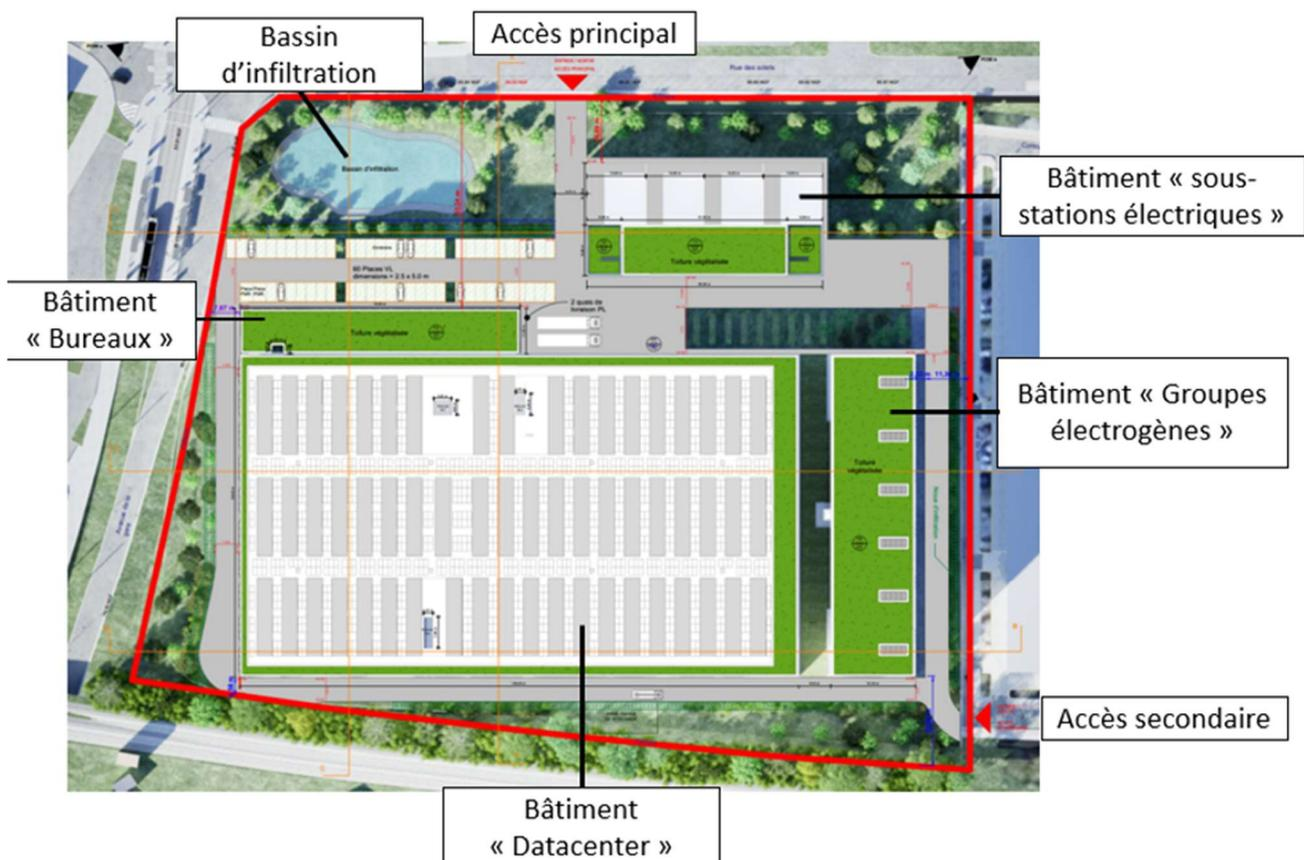
Figure 4 : Plan masse du projet (source : ENIA)
