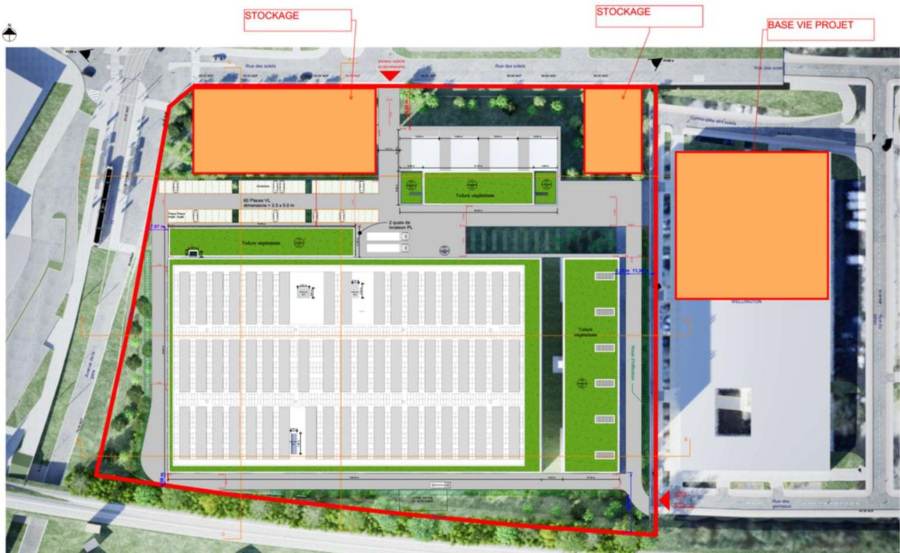
Figure 25 : Localisation de la base vie et des espaces de stockage pour la phase travaux (source : Imogis)
