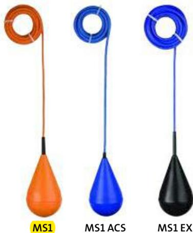
Les régulateurs de niveau régulent le niveau de liquide dans un réservoir, un poste, aussi bien en adduction qu'en assainissement pour tous les transferts de liquide pompé, les alarmes de niveau,... Les régulateurs de niveau ne contiennent pas de mercure et peuvent fonctionner avec tous modèles de pompes, y compris les moteurs anti-déflagrants.
