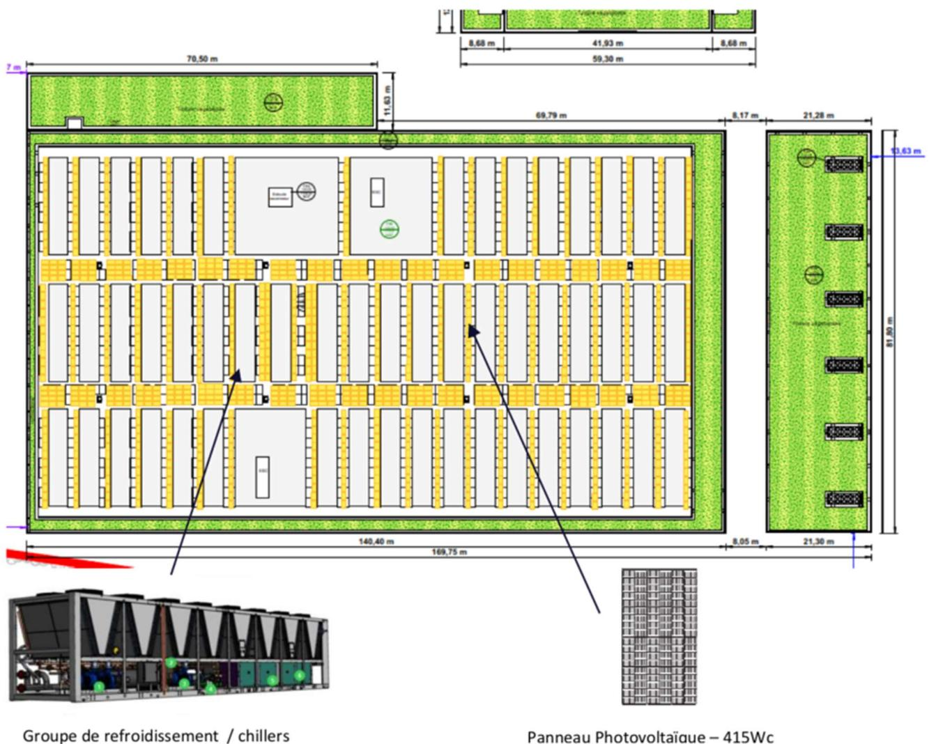
Figure 5 : Disposition schématique des panneaux photovoltaïques sur la toiture (source : Imogis)
