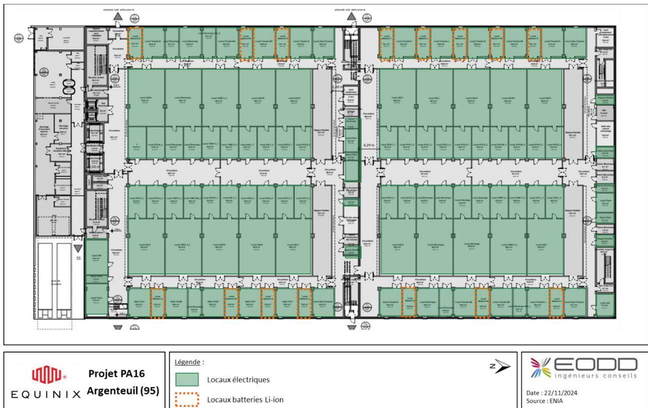
Figure 34 : Identification des locaux électriques dans le bâtiment principal – RDC
