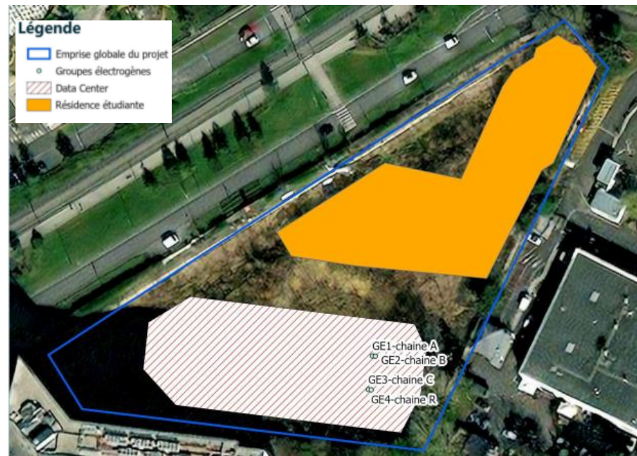
Localisation des cheminées des GE en toiture du bâtiment
