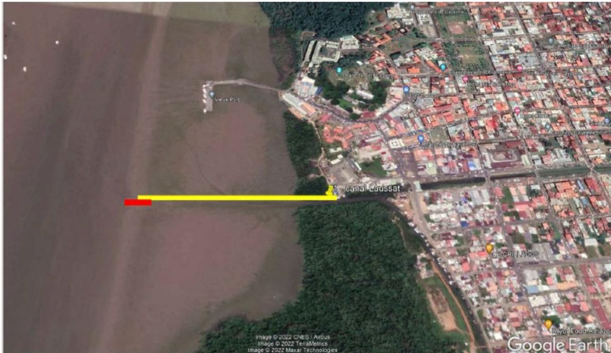
Figure 5 : Implantation proposée de l'embarcadère en dehors de la mangrove et dans le lit mineur de la rivière Cayenne au niveau du site du Canal Laussat (longueur de l'estacade de 500 à 600m)
