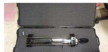
Figure 9 : Hydrophone fixe utilisé dans le cadre du suivi par acoustique
