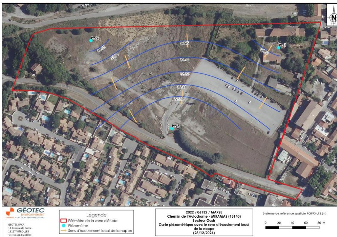
Figure 11 : Carte piézométrique avec le sens d'écoulement local de la nappe de la ZAC OASIS (source : Etude de sites et sols pollués – Prestation DIAG, 220613201, GEOTEC, février 2024)
