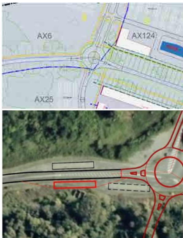
Figure 17 – le schéma retenu : un carrefour giratoire aménagé sur l'emprise du carrefour existant avec le débouché de la quatrième branche sur la parcelle AX 25
