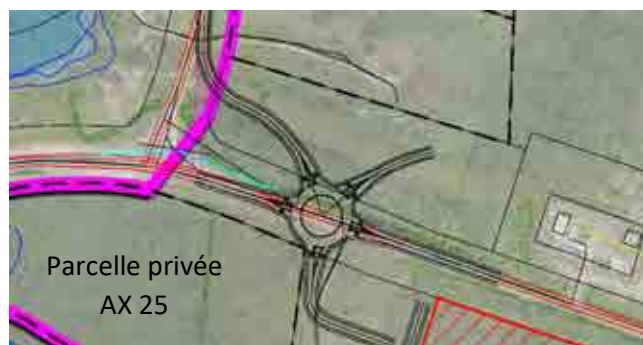
Figure 13 - Évitement par décalage du tracé et aménagement d'un carrefour à 5 branches concentrant desserte et échanges
