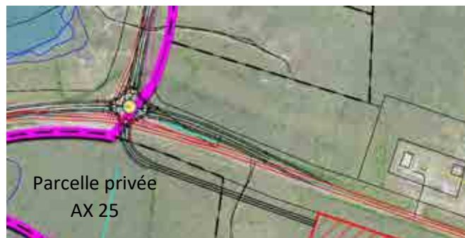
Figure 11 - Aménagement d'un carrefour à quatre branches sur la plateforme existante et création d'une contre allée au Sud
