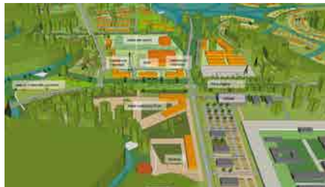
Figure 16 - Principe de dédoublement du carrefour et d'organisation des constructions le long d'une contre allée
