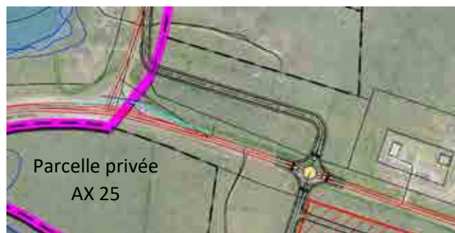
Figure 12 - Évitement de la parcelle AX 25 avec décalage à l'Est du carrefour au droit de la parcelle APIJ et dévoiement de la RD9 par une contre-allée
