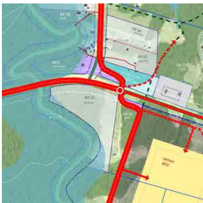
Figure 14 - Impact sur le découpage foncier : scénario d'un carrefour unique central versus dédoublement et contre allée
