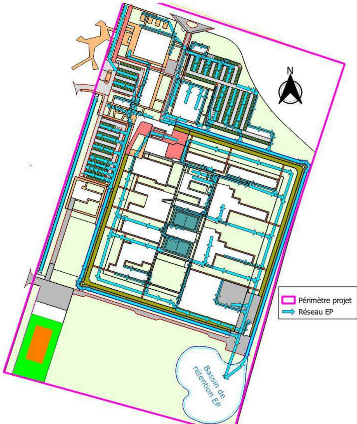
**Figure 20. Plan de principe du réseau EP**
