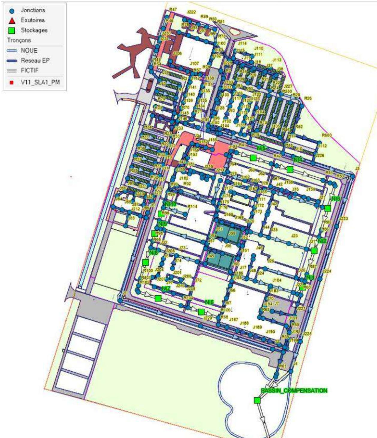
Figure 46. Plan du réseau EP projet
