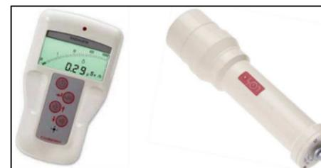
Figure 6. Photographie du Radiagem 2000 et d'une sonde SG-2R.
