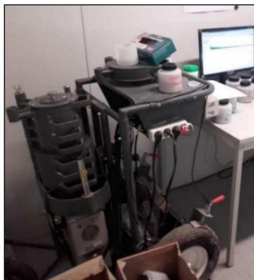
Figure 4. Photographie de la chaîne de spectrométrie gamma GeHP
