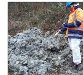
Figure 7. Photographie d'une mesure sur les sols extraits des fouilles.
