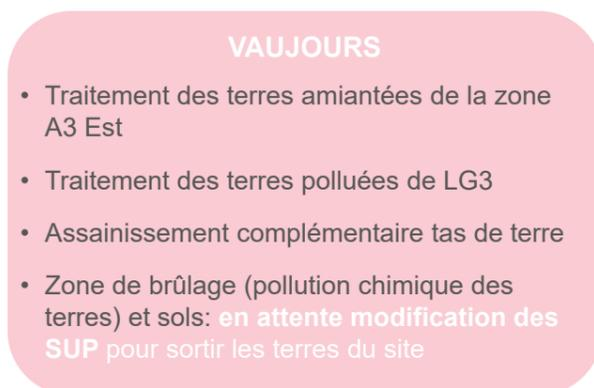
FIGURE 14 : Synthèse de l'avancement des démolitions et dépollutions (périmètre de la demande)
