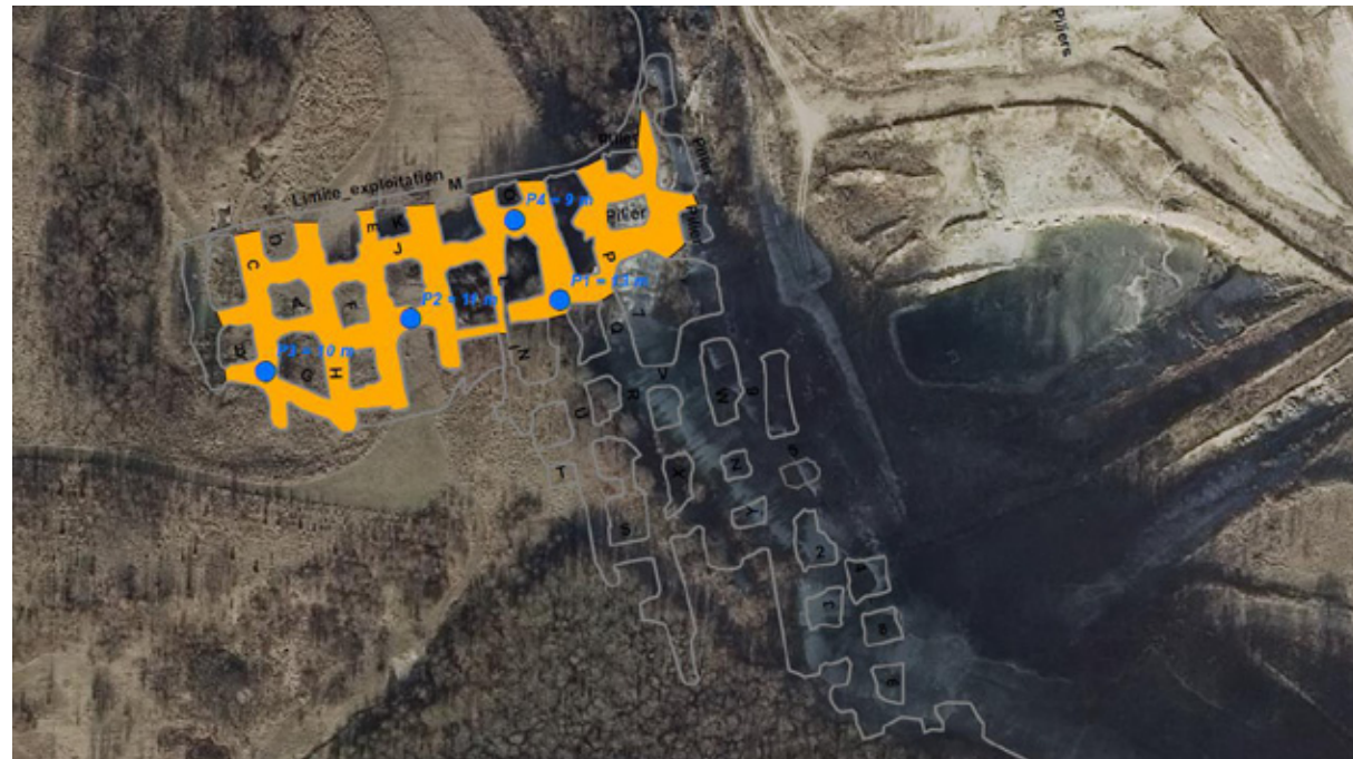
Figure 2 : Plan indicatif des vieux cavages Ouest. En orange les zones qui seront conservées et en transparent les zones qui seront remblayées.
