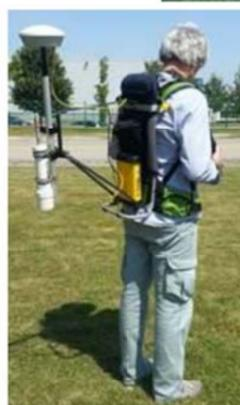
**Exemples d'équipements industriels pour le contrôle de grandes surfaces avec positionnement GPS et trajectoire associée**
