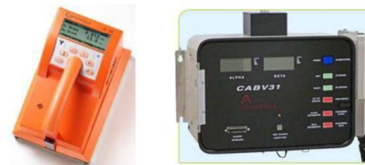
Exemples d'équipements de détection de contamination
