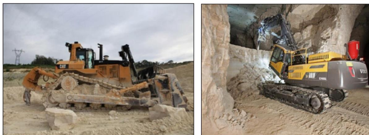
La technique de ripage consistera à utiliser le poids et la puissance du bulldozer pour débiter le gypse, en creusant des sillons à l'aide d'une dent de ripage installée à l'arrière de l'engin. Le front de gypse sera donc entamé par le dessus. Le bulldozer constituera des stocks de gypse, qui seront ensuite repris à la chargeuse pour alimenter le pré-concasseur (cf. § 3.2.7).
