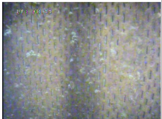
Au-delà de 11 m, le dépôt et les concrétions semblent plus présents sur la paroi acier, colmatant ainsi certaines fentes de crépine (environ 20%).
