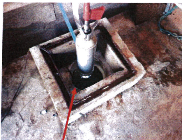
Figure 4 : Référence de la cote 0 de l’inspection vidéo et des diagraphies du 25/07/19 (soit + 122,45 m NGF)
