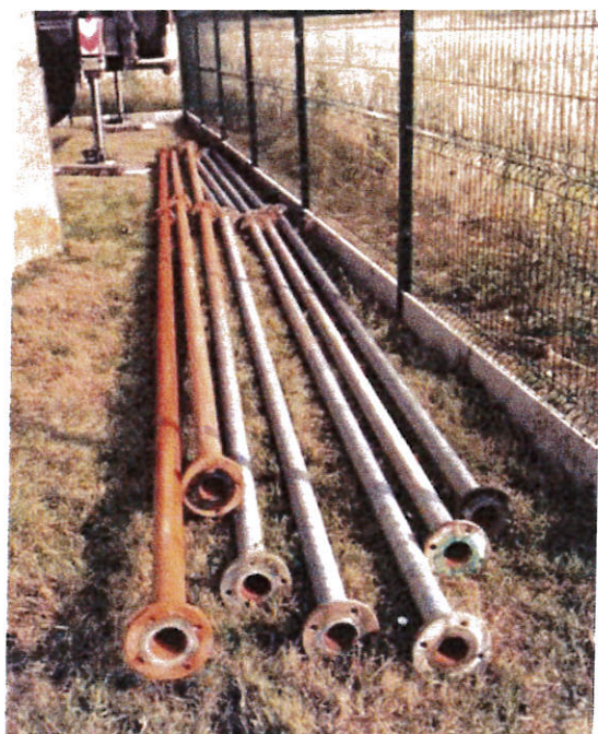
Figure 10 : Etat de la colonne d’exhaure à brides à l’issue du retrait du 24/07/18 (aperçu de la corrosion avancée des tubes immergés)
