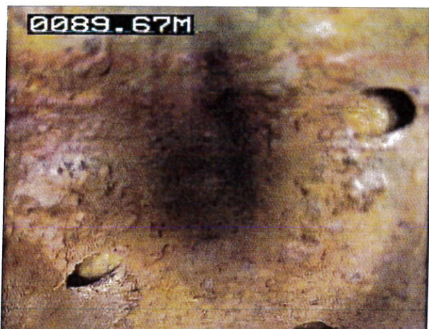
89, 60 : Fin du tube acier 300 mm, apparition du terrain nu (calcaires de Brie)
