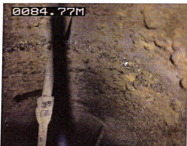
Réduction annulaire (85,03 m) non mentionnée sur la coupe d'archives. Tube crépiné largué e 250 mm
