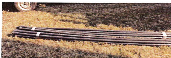
Figure 12 : Nouveaux équipements poses les 25 et 26/07/18 : Pompe Pleuger NB65-15+M6-270-2 , Colonne inox 304 L 2 mm DN65 à raccords ZSM, tube guide-sonde PE Ø 32 mm
