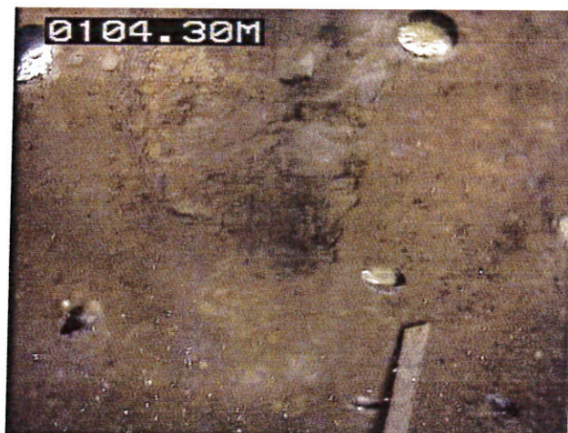
Changement de terrain à l'arrière – Calcaire plus blanchâtre
