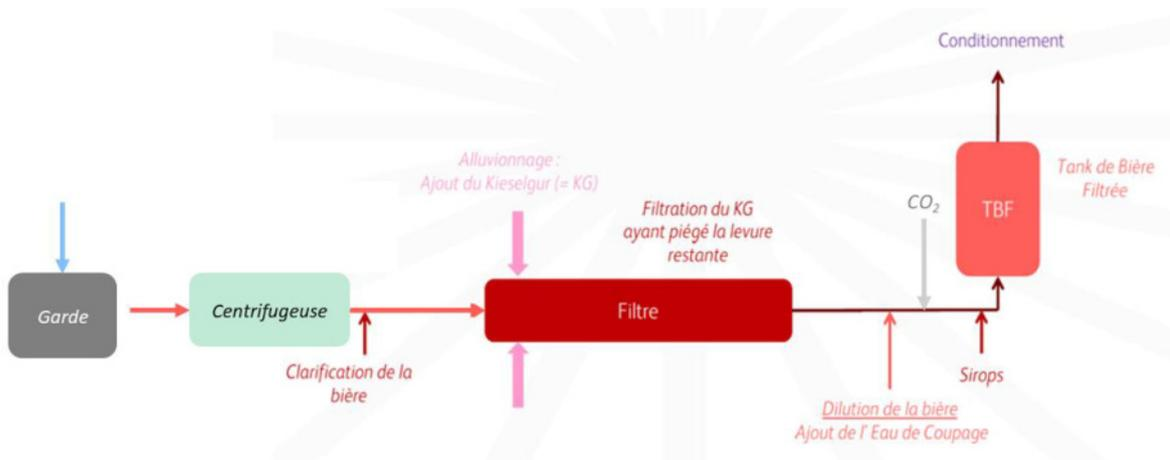
Figure 5 : Schéma de filtration (source : Heineken)
