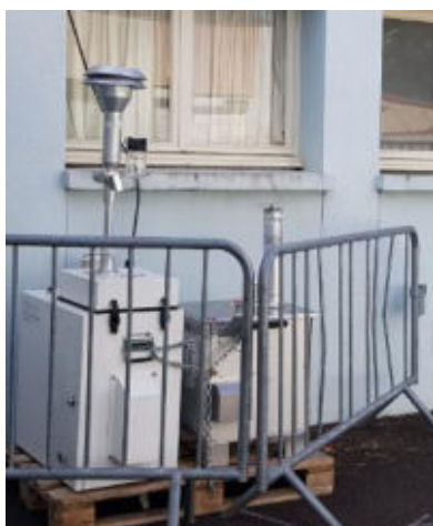
Figure 7 : Partisol 2025i (gauche) et Skypost PM (droite)
