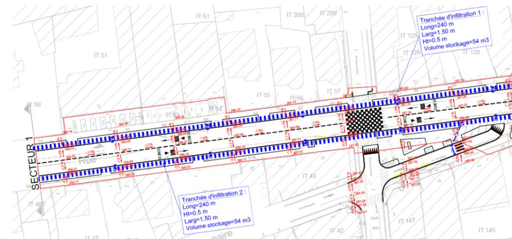
Figure 149 : Localisation des tranchées d'infiltration dans le secteur 2 (partie Est)
