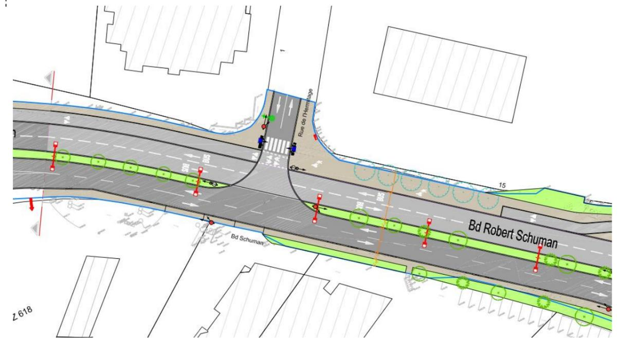
Figure 76 : Plan d'insertion du projet de BHNS sur le boulevard Schuman en site propre latéral nord (AVP)
