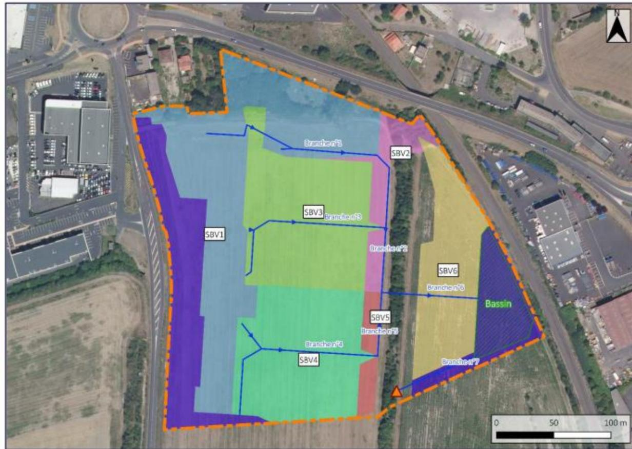
Figure 168 : Schéma de principe du réseau de collecte des eaux pluviales
