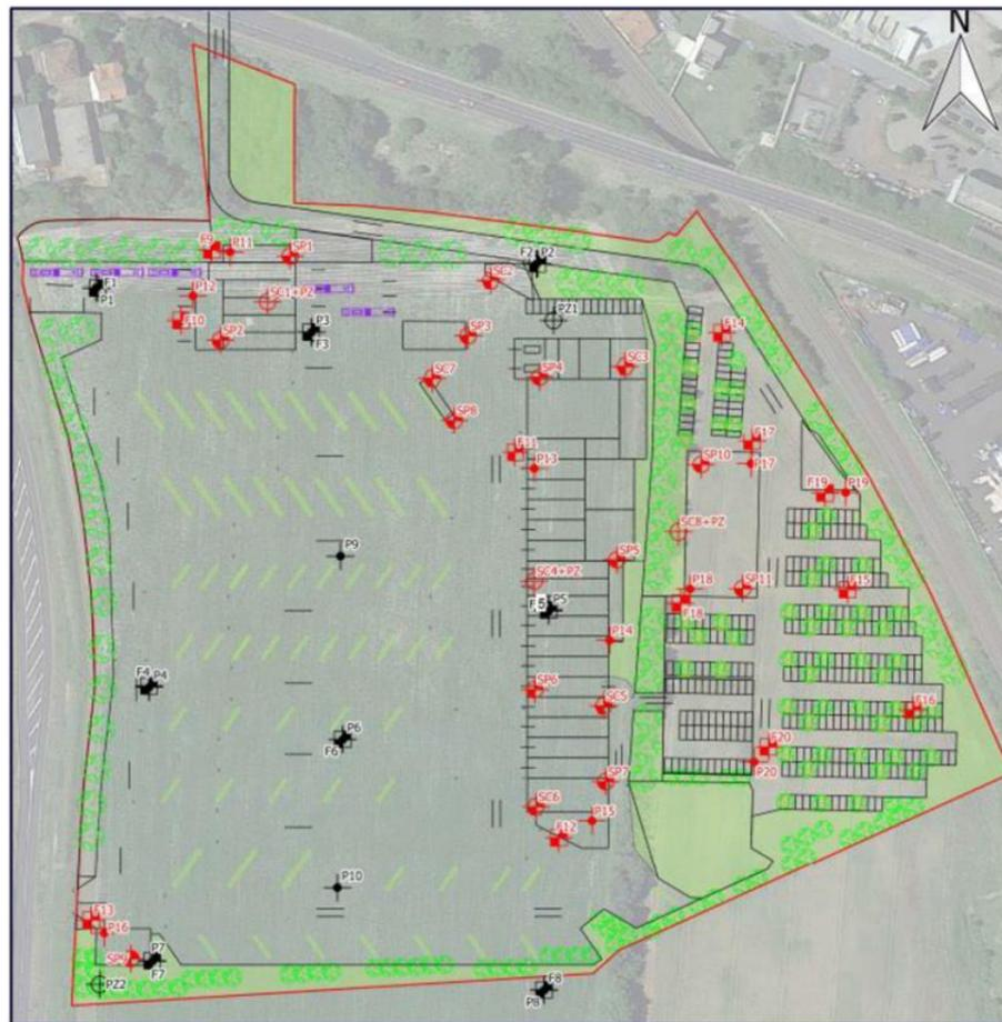
Figure 126 : Plan d'implantation des sondages (rouges) et des essais de perméabilité (noirs)
