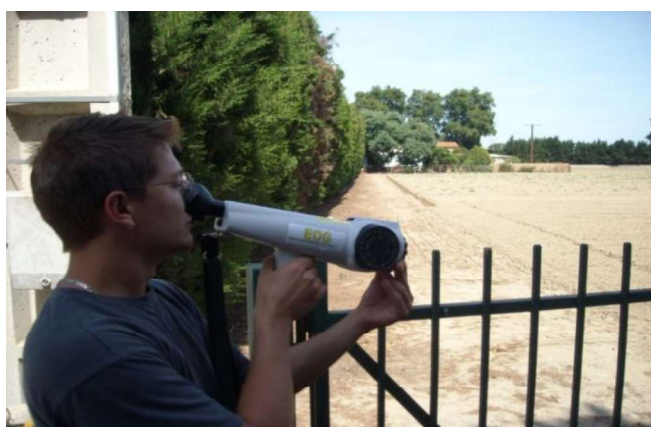
PHOTOGRAPHIE 2 : MESURE DE LA CONCENTRATION D'ODEURS A L'AIDE D'UN OLFACOMETRE DE TERRAIN
