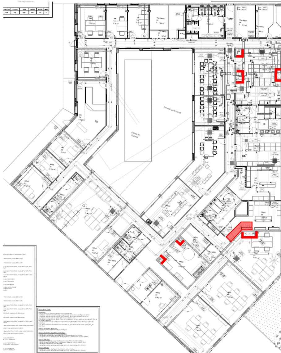
→ Gains et coffrage placostil sur ossature avec 1 BA 18S + laine de verre 45 mm + 1 BA 18S + laine de verre 45 mm dans la gaine technique
