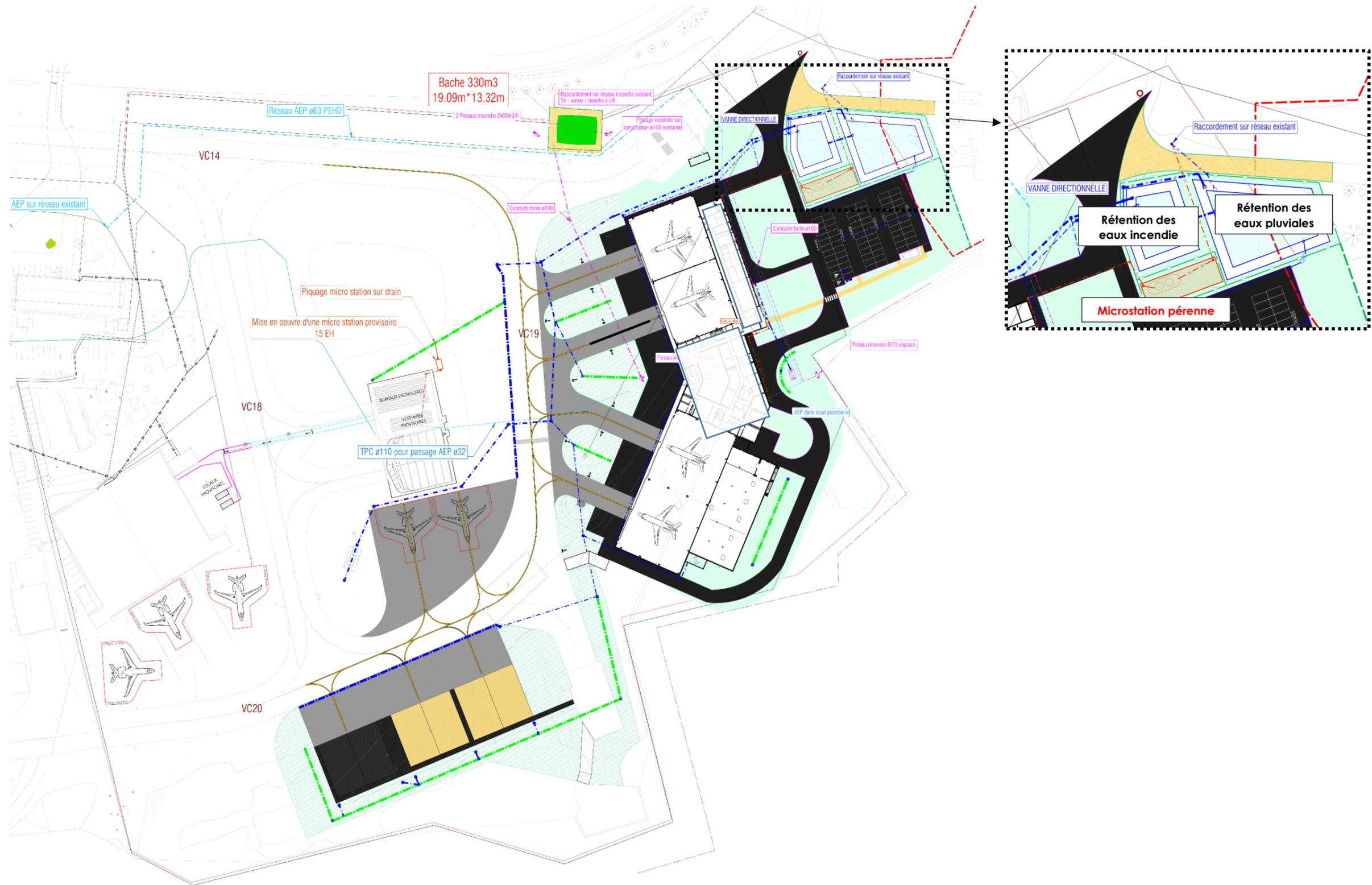
Figure 13 : Plan d'implantation des réseaux définitifs et localisation de la microstation pérenne
