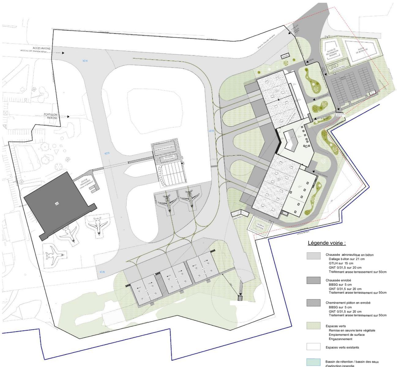
Figure 5 : Plan masse des superficies imperméabilisées
