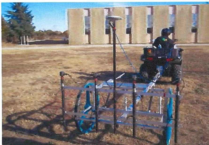
*Photo d'une opération de sondage magnétométrique (sondes magnétométriques tractées par un quad)*
