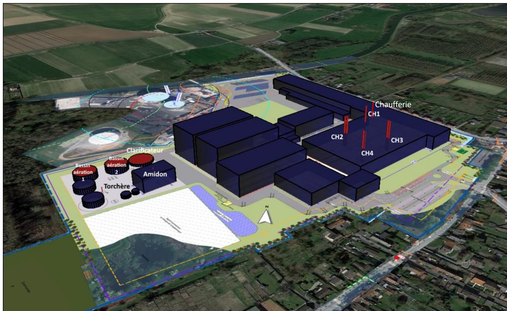
Figure 1 : Localisation des points de rejets atmosphériques du projet Agristo (Source : Aconstruct)
