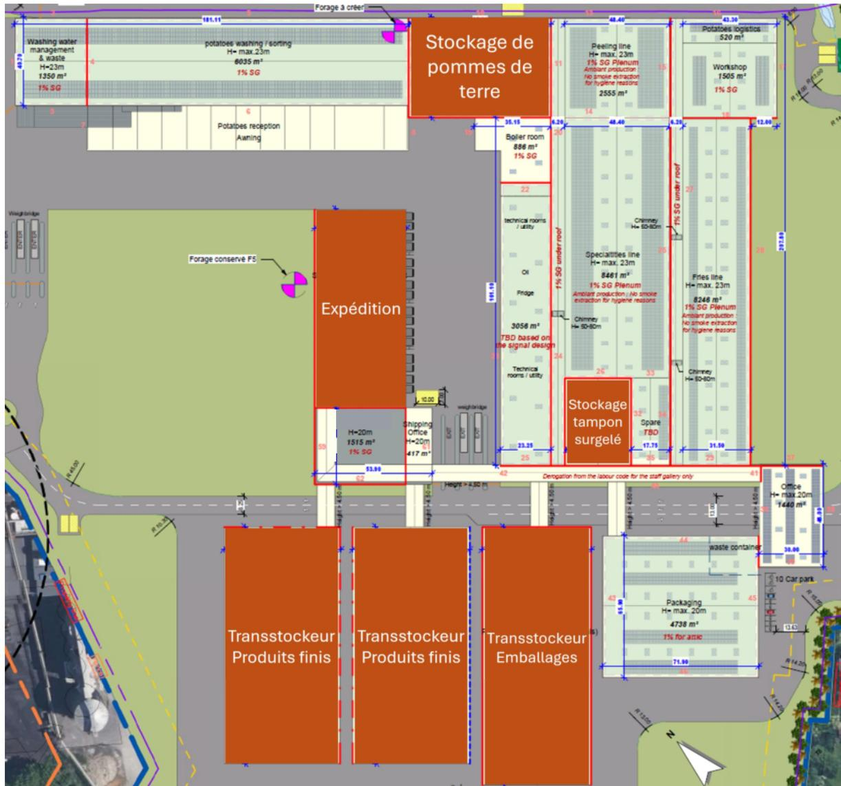
Figure 38 : Emplacement des stockages dont l'incendie est modélisé
