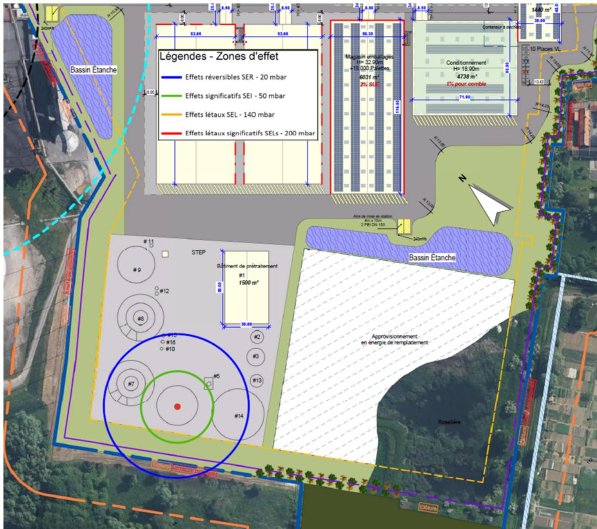
Figure 69 : Modélisation des effets de surpression – Digesteur UASB
