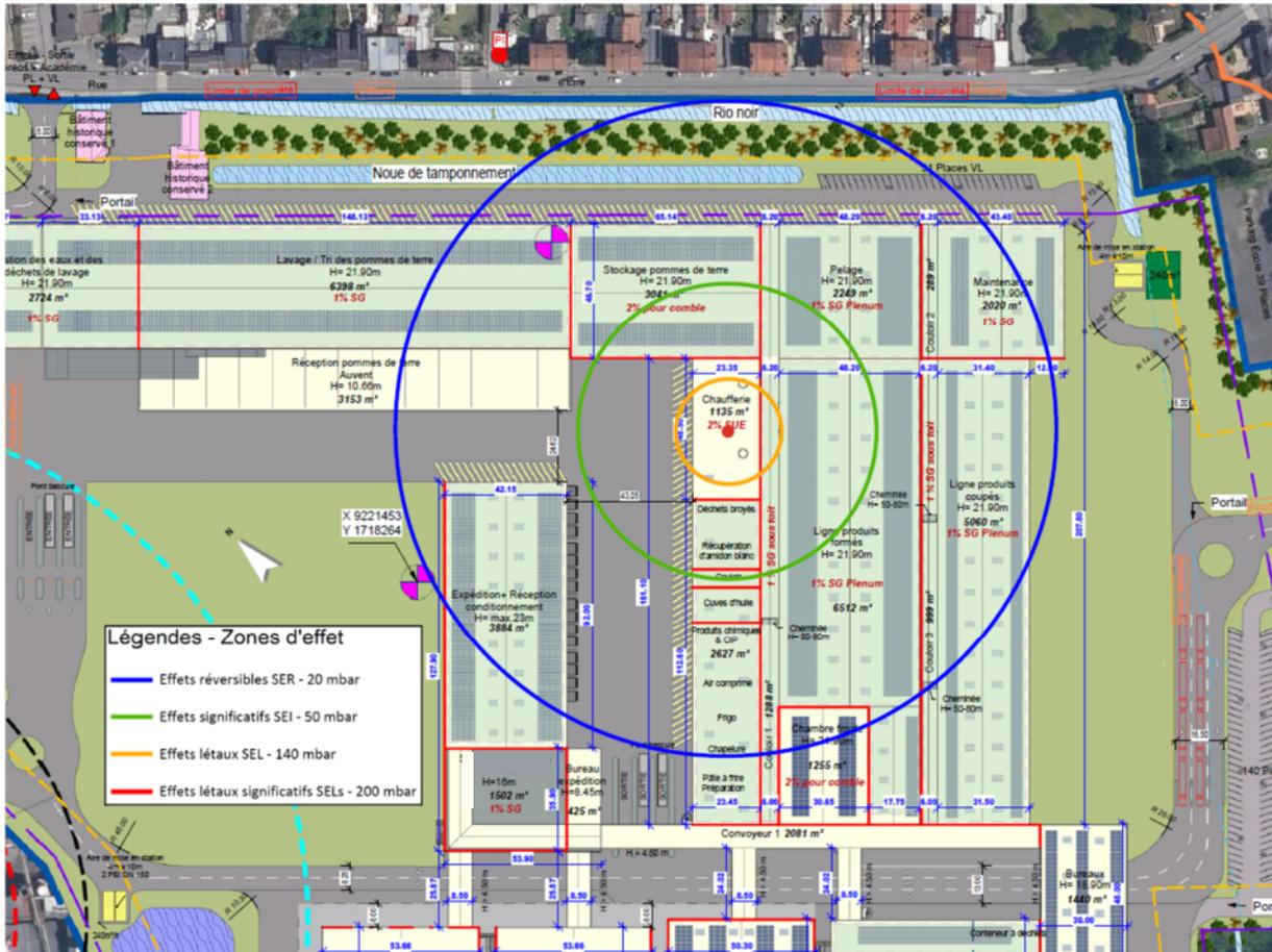
Figure 68 : Modélisation des effets de surpression – Chaufferie
