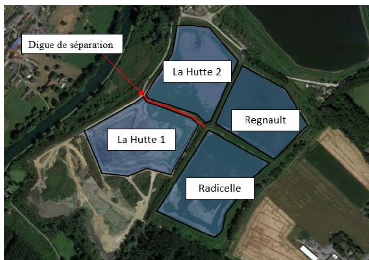
Figure 13 : Localisation de la digue séparative
