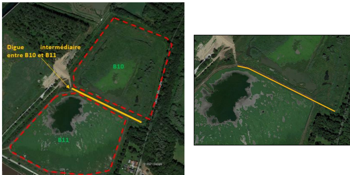
Figure 30 : Digue intermédiaire entre B10 et B11
