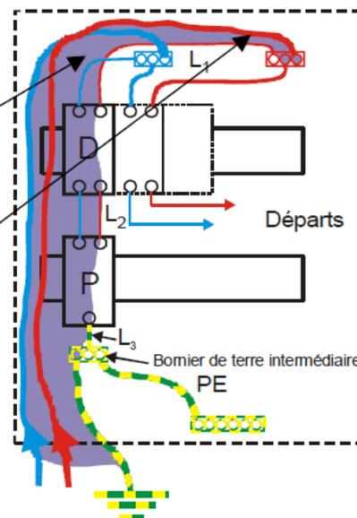
Figure 10 – Exemple de câblage dans un tableau électrique
