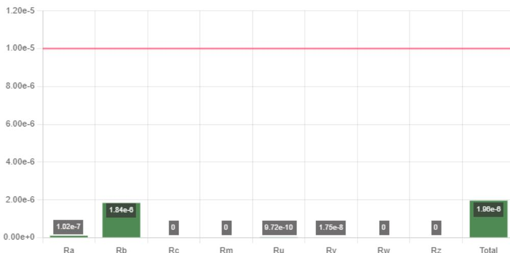
Résultat de l'Analyse de Risque Foudre : Avec protection de niveau IV contre les effets directs et indirects de la foudre
