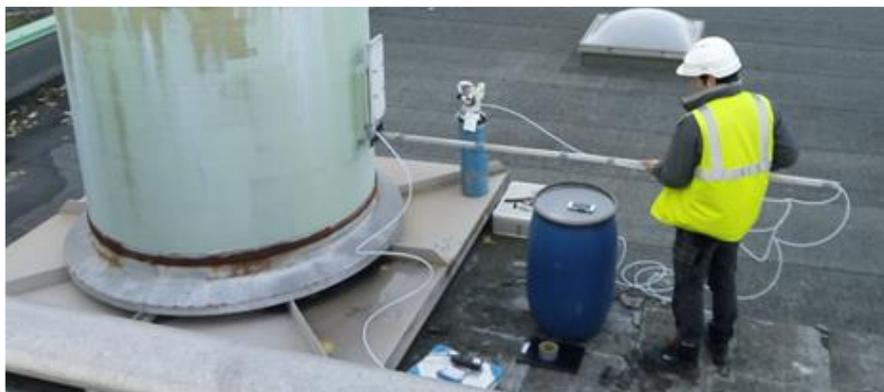
Echantillonnage sur source canalisée
