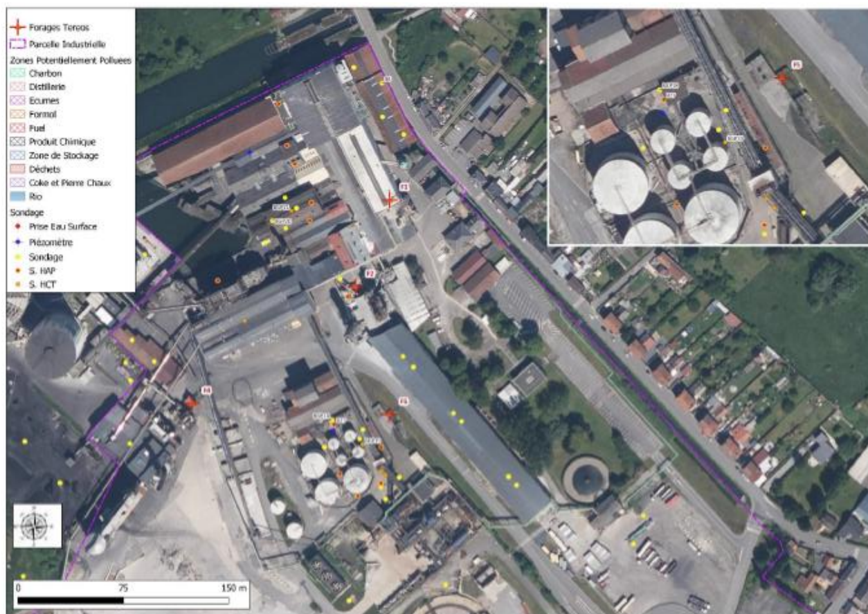
Figure 30 : Sondages avec des traces de COHV
