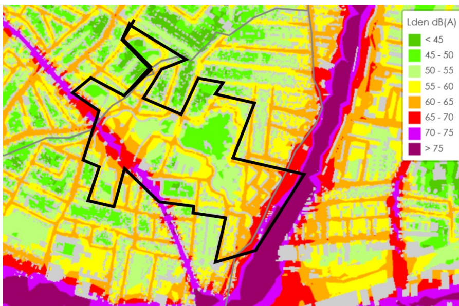
Figure 3: carte de bruit issue du site de Bruitparif qui montre des intensités sonores très élevées notamment le long des axes de circulation (secteur des Équerres et de la rue Édouard Vaillant) alors que le dossier ne semble pas faire de l'isolation acoustique des habitations maintenues une priorité.
